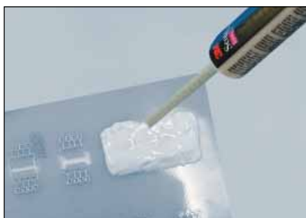
Inkapselen van geheugenchips voor bescherming tegen losbreken 3M Scotch-Weld DP 760
