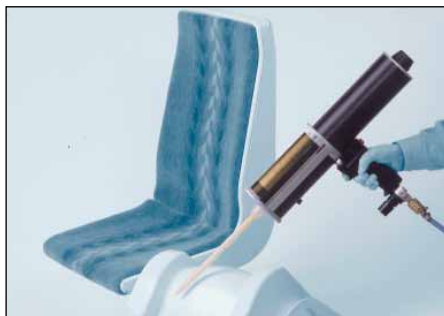
Het lijmen van een stoelzitting op ABS gietvorm 3M Scotch-Weld DP 190
